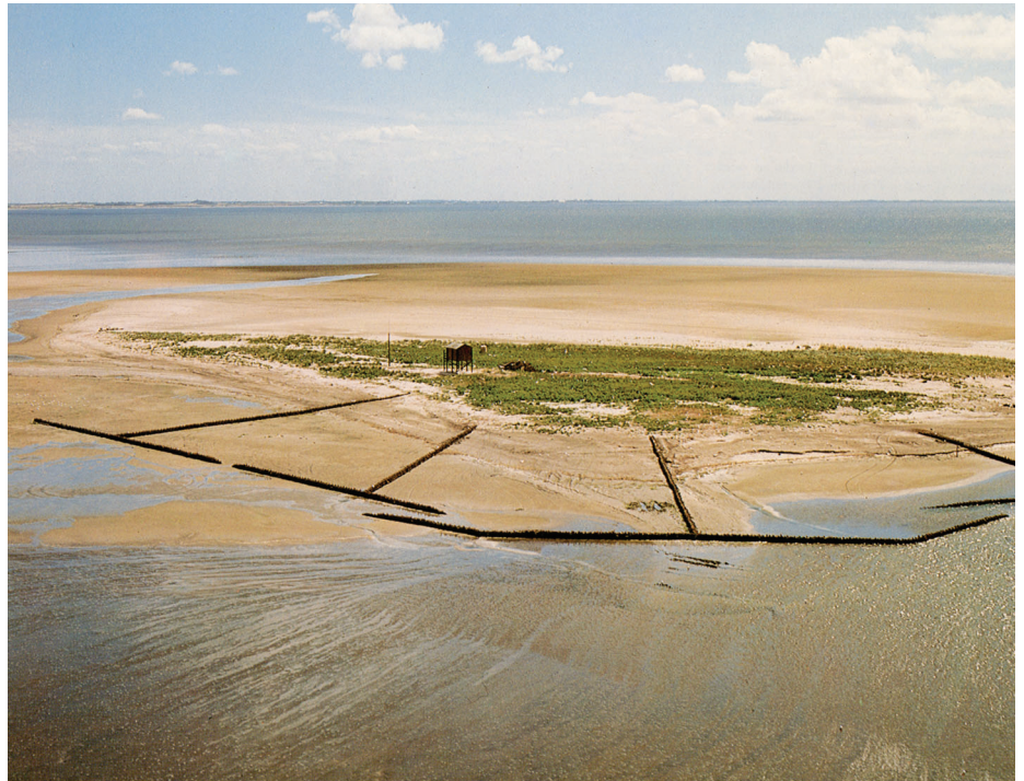
Luftaufnahme von Jordsand am 22. Juli 1976. Die ersten Lahnungsfelder sind im Westen und Norden errichtet worden, um die bedrohten Küstenstreifen zu sichern.
