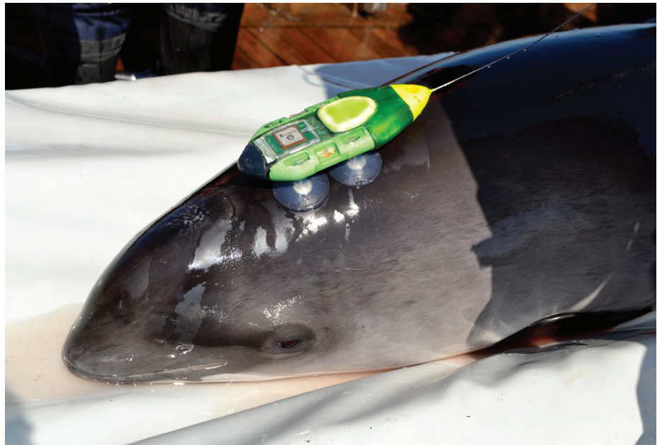
Die akustischen Datenlogger zeichnen auf, wo sich die Tiere befinden, wie tief sie tauchen, welche Signale sie senden und empfangen, welchem Lärm sie ausgesetzt sind, wann sie sich ausruhen und wann sie jagen.
