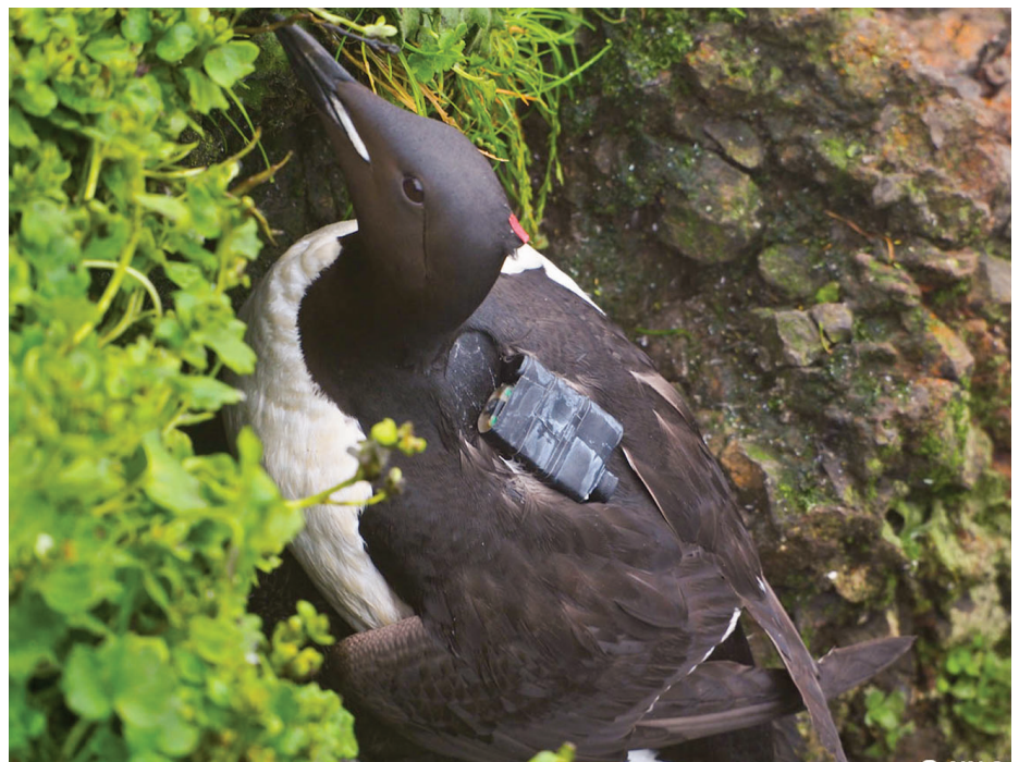
Auf dem Rücken der Dickschnabellumme wurden ein Datenlogger und eine winzige Videokamera befestigt. Foto: Nobuhiko N. Sato
